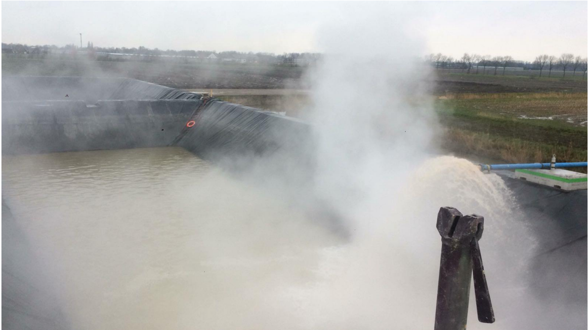
Het testwater wordt opgevangen in het bassin. De temperatuur is rond de 80 graden. (foto Bertran de Lange)
